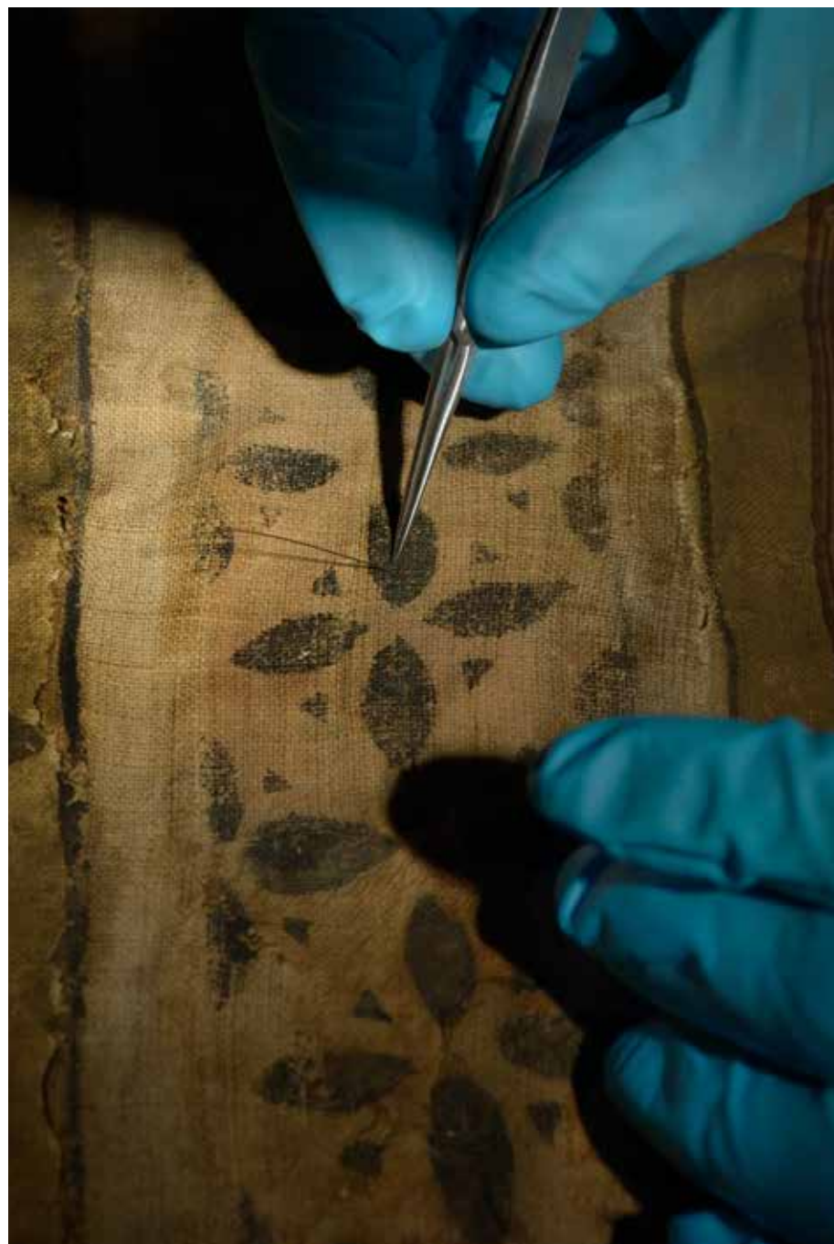
Probeentnahme an der Malschicht des Fastentuchfragments für die Untersuchung von Pigmenten und Bindemitteln
